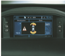
Indication visuelle de l'aide au stationnement avant et arrière
