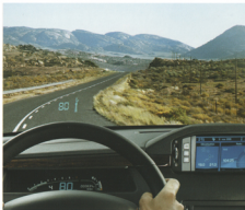
Affichage tête haute sur le pare-brise
